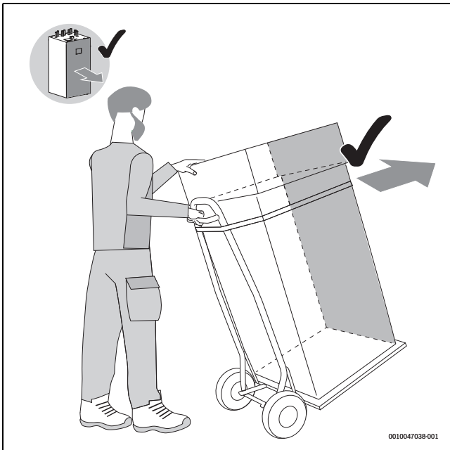
Bild 9 Inneneinheit mit einer Sackkarre transportieren
