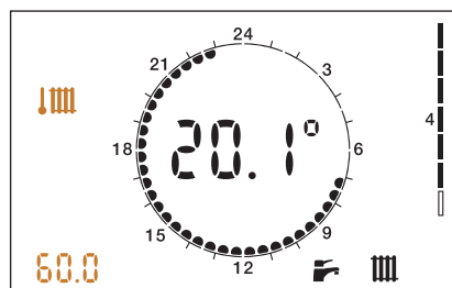
Vorlauftemperatur der Heizungsanlage
