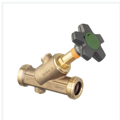
Easytop-KRV-Schrägsitzventil (Kombiniertes Freistromventil mit Rückflussverhinderer) Modell 2238.3 Artikel 757 304
