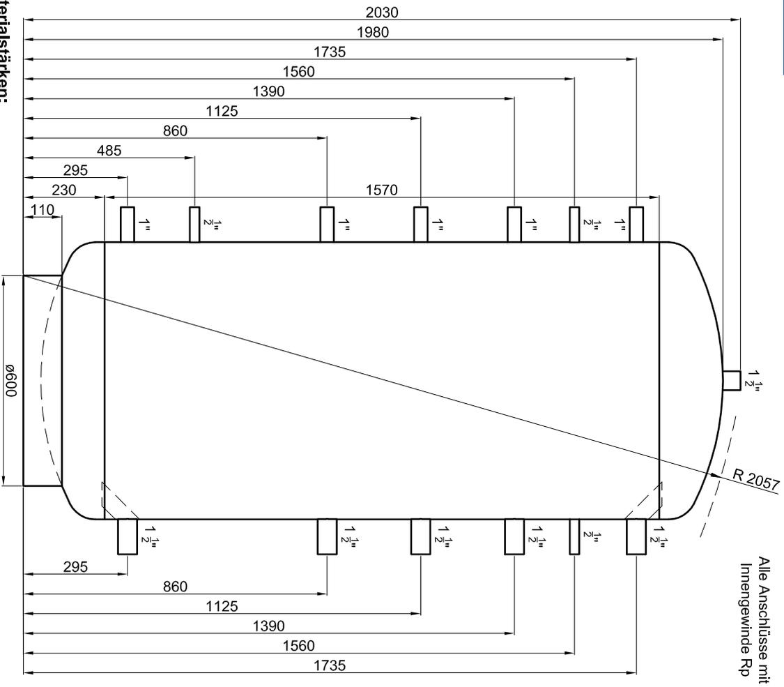
Alle Anschlüsse mit Innengewinde Rp
