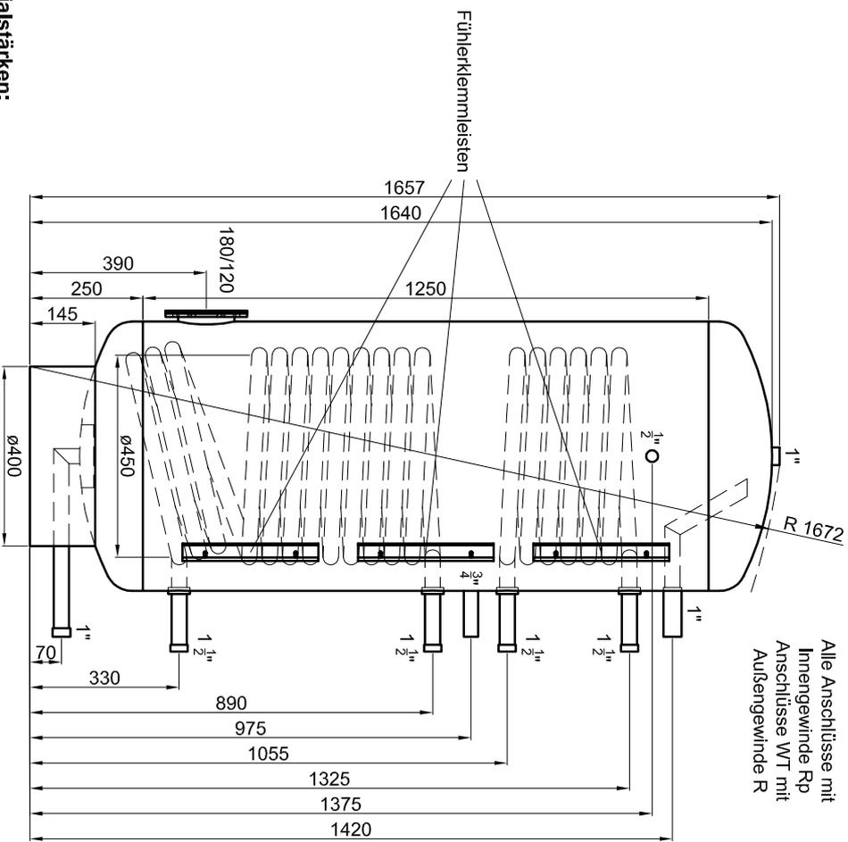
Alle Anschlüsse mit Innengewinde Rp
