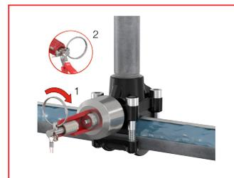
Drehen Sie den Trigger auf den T-plus. Positionieren Sie den Ring in die komfortabelste Zugrichtung (1). Schneiden Sie den Plombendraht durch (2).
